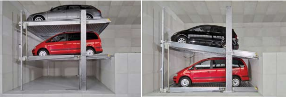
Vista laterale del Parklift 430 che evidenzia le varie inclinazioni possibili delle due piattaforme per modificare l'altezza a seconda delle vetture da parcheggiare.
