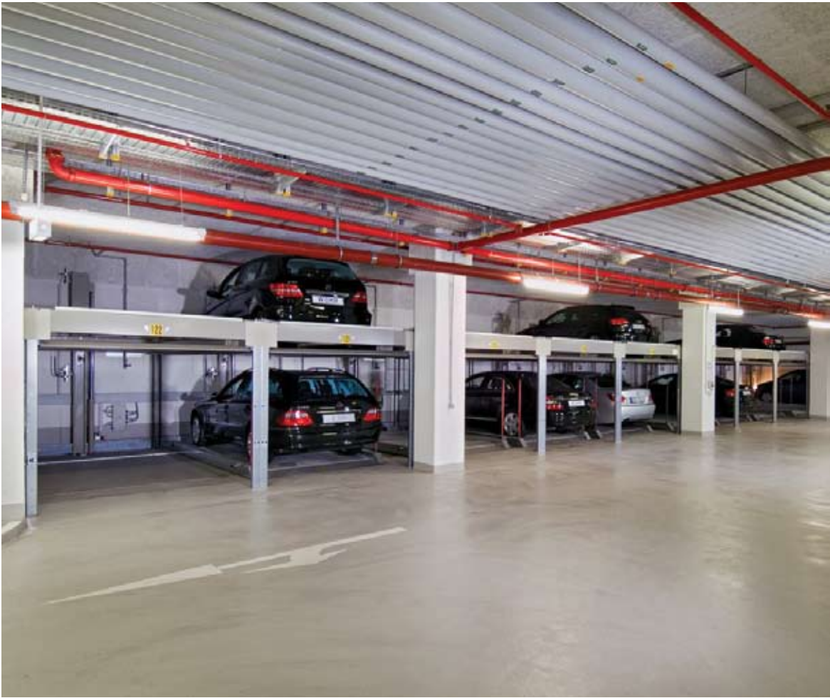
Sistema di parcheggio Combilift 551 con due livelli di parcheggio ed una sola corsia di manovra installato fuori terra e senza eseguire scavi. I posti auto sono tutti indipendenti.
